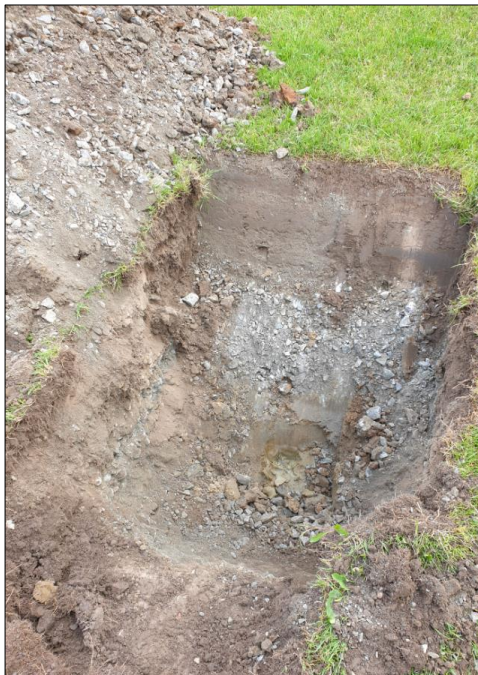
Figur 5. PG6 i mulljord. Ca 0,5 m mulljord och fyllnadsmassor på lera.
