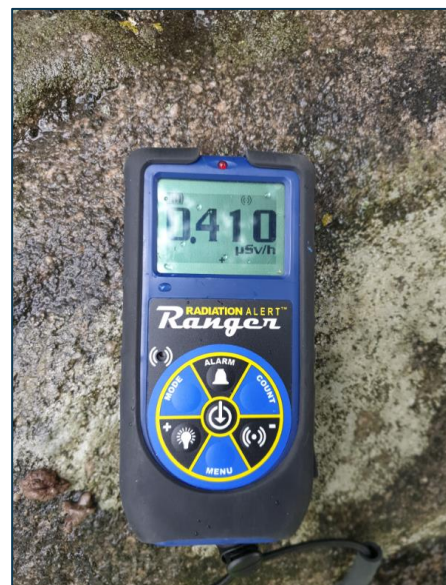
Figur 8. Mätning på frilagt berg, gammamätaren visa 0,41 \mu\text{Sv/h} .
