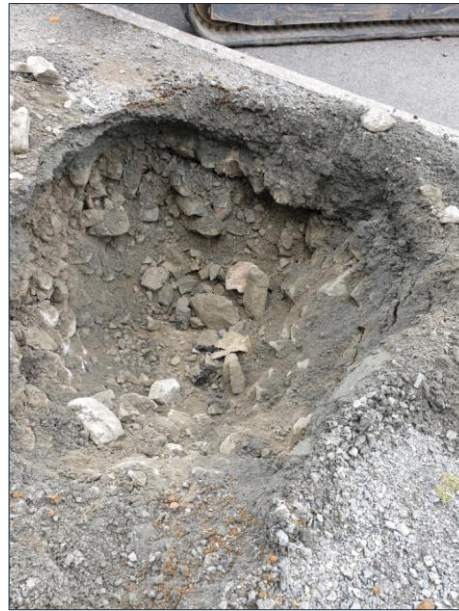
Figur 4. Sandiga och grusiga fyllnadsmassor med inslag av gammal asfalt i PG11.
